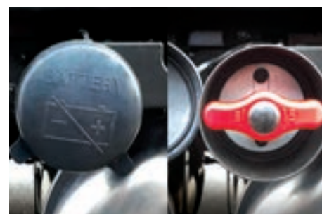
배터리 컷오프 스위치 장기 주차 시 배터리 방전 방지 및 편의성 증대
